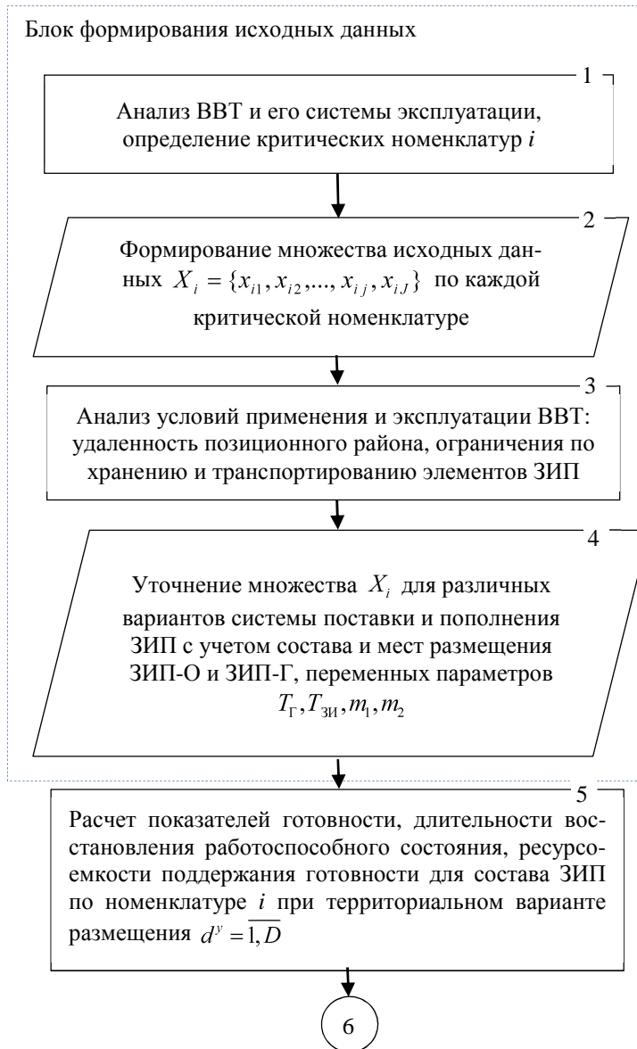
Рис. 1. Блок-схема методики выбора параметров системы пополнения многономенклатурного комплекта запасных частей (начало)
