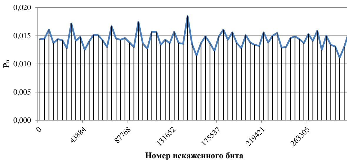
Рис. 5. Гистограмма распределения места возникновения битовой ошибки
