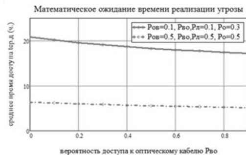
Рис. 7. Математическое ожидание времени реализации атаки при t_{CC} = 2 ч, t_{OC} = 1 ч, t_{OB} = 0,5 ч, t_{ПОВ} = 1 ч
